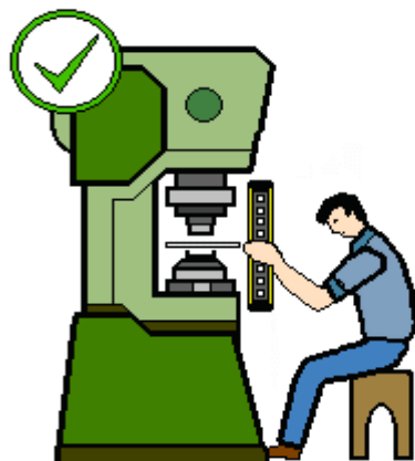
Zabezpieczenie od frontu
